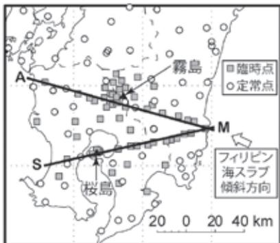
図5 南九州地域の地震観測点(○定常、□臨時)とレシーバ関数解析の測線(MA:宮崎－阿久根測線、MS:宮崎－桜島測線)
