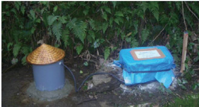
写真4 屋外に設置された臨時観測点の様子。左の筒の中に地震計、右の青いビニールのかかった箱の中にバッテリーとデータ収録装置が納められている(宮崎県北諸県郡山田町倉平)。
