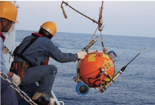
写真3 観測船から投入される海底地震計(上)、回収された海底地震計(下)
